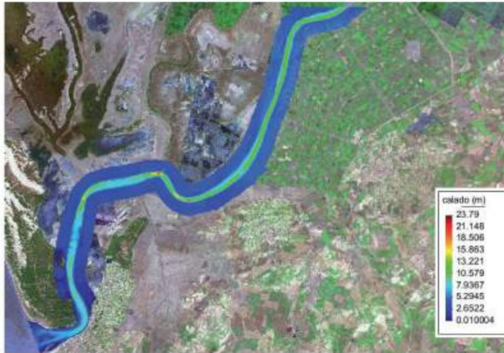
Modelo IBER para la determinación de la vulnerabilidad de lasotas de protección existentes
